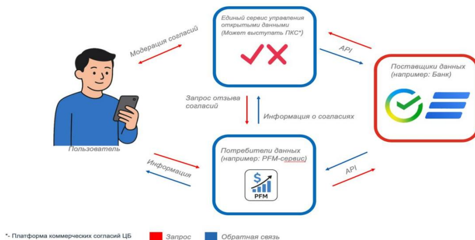
Рис. 3. Архитектура взаимодействия на базе Открытых API
